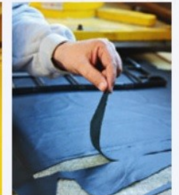
MIT GLEICHMÄSSIGEM DRUCK Unter einer Presse werden die Stanzformen auf dem glatt ausgelegten Leder angeordnet. Das Ergebnis: in kürzester Zeit perfekte Einzelteile für jeden Bezug
