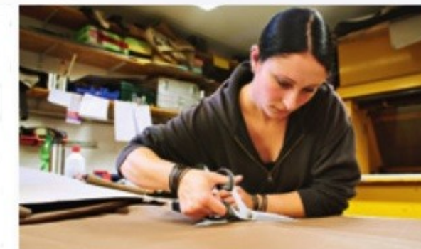
HANDARBEIT BEI KLEINSERIEN UND EINZELSTÜCKEN Weniger gängige Sitze oder Einzelanfertigungen werden von Hand nach Pappschablonen und Kreidestrichen ausgeschnitten
