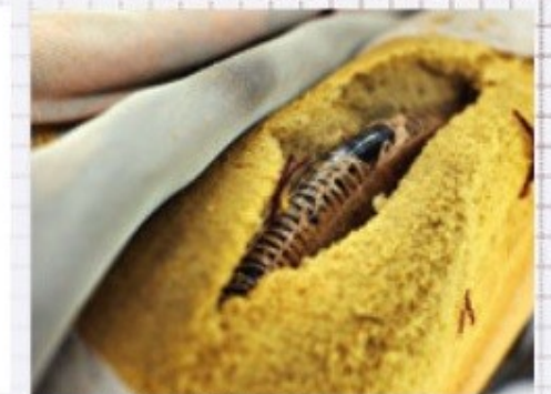
DAS GRAUEN LAUERT UNTERM STOFF Gerade Schaumstoffe zur Polsterung altern – hier hat sich der Sitzrahmen mit den Jahren durchgearbeitet
