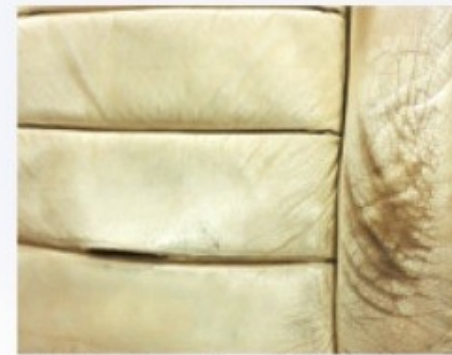
WENN AUSBESSERN NICHT MEHR HILFT Oft kann man gerade Lederausstattungen noch retten, doch großflächig durchgewetzte Stellen wie im Bild links oder brüchiges und sprödes Leder, wie rechts zu sehen, lassen sich nicht mehr kaschieren. Da hilft nur noch ein Neubezug – individuell angepasst oder ganz originalgetreu
