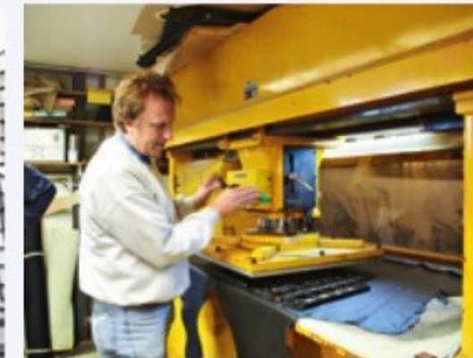
MIT GLEICHMÄSSIGEM DRUCK Unter einer Presse werden die Stanzformen auf dem glatt ausgelegten Leder angeordnet. Das Ergebnis: in kürzester Zeit perfekte Einzelteile für jeden Bezug
