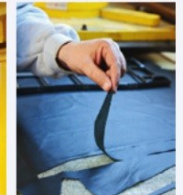
MIT GLEICHMÄSSIGEM DRUCK Unter einer Presse werden die Stanzformen auf dem glatt ausgelegten Leder angeordnet. Das Ergebnis: in kürzester Zeit perfekte Einzelteile für jeden Bezug
