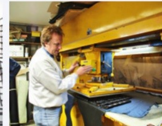
MIT GLEICHMÄSSIGEM DRUCK Unter einer Presse werden die Stanzformen auf dem glatt ausgelegten Leder angeordnet. Das Ergebnis: in kürzester Zeit perfekte Einzelteile für jeden Bezug
