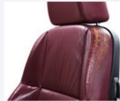
WENN AUSBESSERN NICHT MEHR HILFT Oft kann man gerade Lederausstattungen noch retten, doch großflächig durchgewetzte Stellen wie im Bild links oder brüchiges und sprödes Leder, wie rechts zu sehen, lassen sich nicht mehr kaschieren. Da hilft nur noch ein Neubezug – individuell angepasst oder ganz originalgetreu
