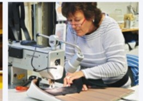
EXAKTES ARBEITEN GEFRAGT Jede Naht muss sitzen! Selbst einfache Sitzbezüge haben rund zehn Einzelteile und viele Steppnähte
