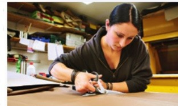
HANDARBEIT BEI KLEINSERIEN UND EINZELSTÜCKEN Weniger gängige Sitze oder Einzelanfertigungen werden von Hand nach Pappschablonen und Kreidestrichen ausgeschnitten
